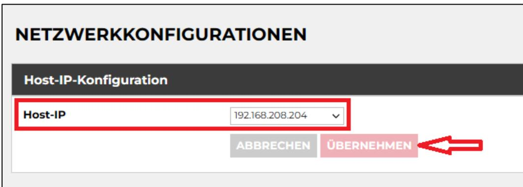
Legen Sie unter "Einstellung" >> "Netzwerkkonfigurationen" >> "Remote Host" den "Auto-Scan Bereich" >> auf "Custom" fest und weisen Sie den IP-Bereich der in der USV installierten RMCARD zu. Klicken Sie nach der Konfiguration auf "Übernehmen".
