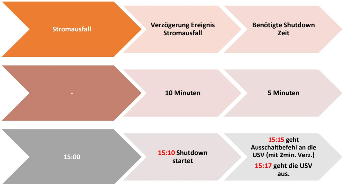
**Hinweis:** Kommt zwischen dem Ereignis Stromausfall und Verzögerung der Strom wieder, wird der Shutdown abgebrochen.
